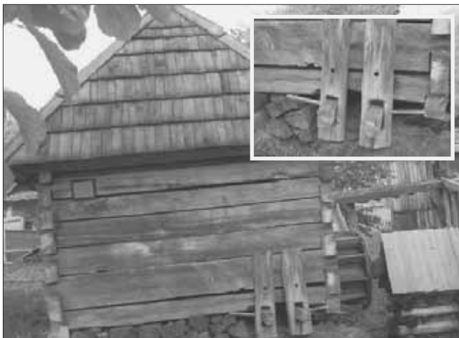
Ступа-сукновальня із с. Монастирець Хустського району та молоти (“клепачі”), якими збивається полотно.
