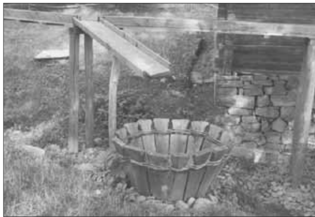
Валило – пристрій для валяння вовняних килимів ("ліжників") із с. Пилитець Міжгірського району.
