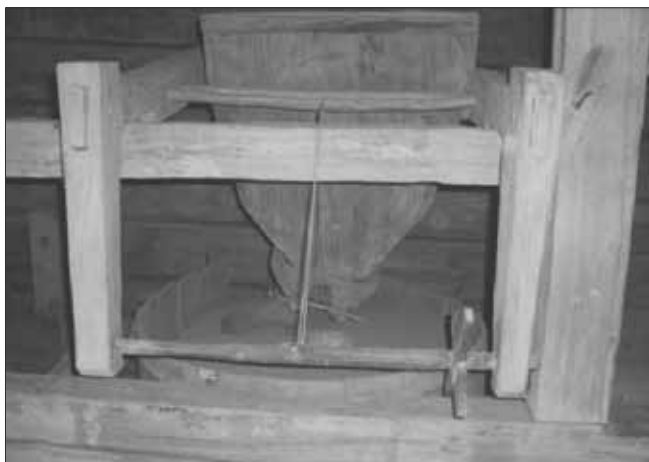
Дощатий кіш ("барабан") для засипу зерна.
